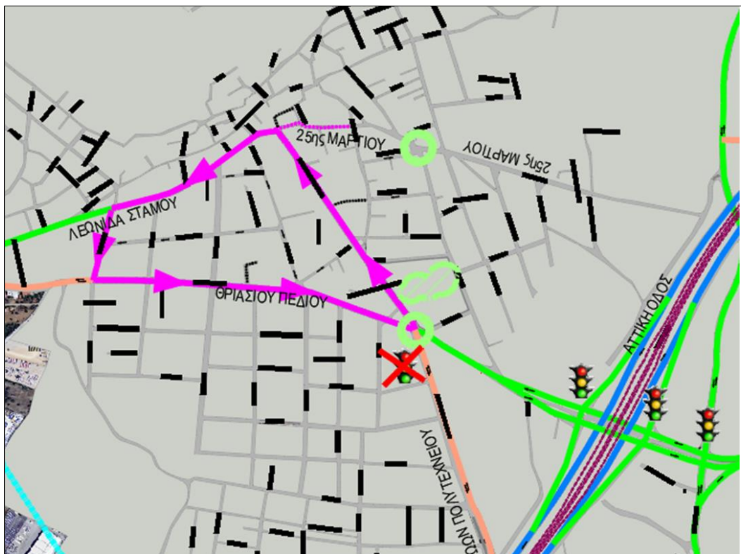
Εικόνα 24: Πρόταση κυκλοφοριακής οργάνωσης στην πόλη της Μαγούλας
