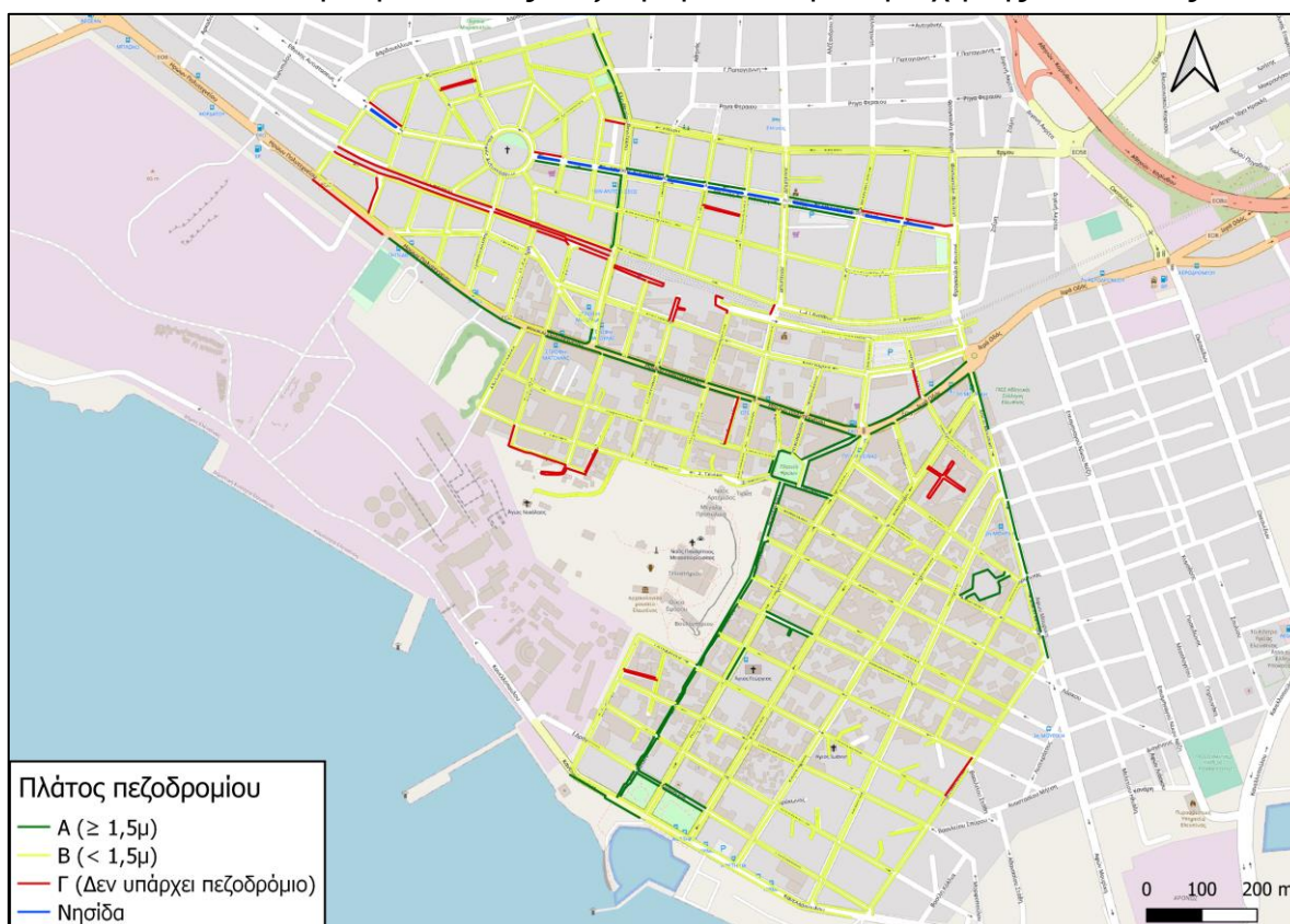
Εικόνα 17: Ωφέλιμο πλάτος πεζοδρομίων στην περιοχή της Ελευσίνας
