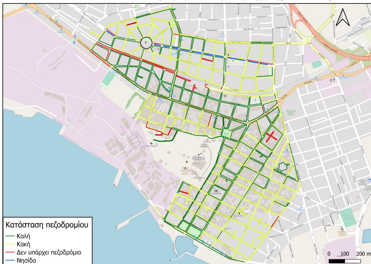
Εικόνα 19: Κατάσταση πεζοδρομίων στην περιοχή της Ελευσίνας
